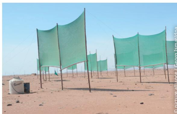
Nebelkollektoren machen das scheinbar Unmögliche möglich. Wenn die feuchten Schwaden durch die dichten Netze ziehen, bleiben winzige Wassertropfchen an den Fasern hängen und laufen dann langsam am Maschenwerk herab in einen Wasserspeicher. Die Idee ist nicht neu, aber verschiedene Forscher arbeiten daran, die Nebelkollektoren effizienter und haltbarer zu machen.
